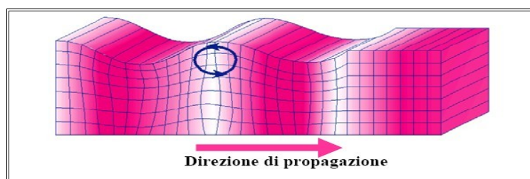
Figura 2 – Rappresentazione grafica della propagazione delle onde superficiali di Rayleigh caratterizzata dall'oscillazione polarizzata in un piano verticale e con movimento delle particelle retrogrado rispetto alla direzione di propagazione dell'onda
