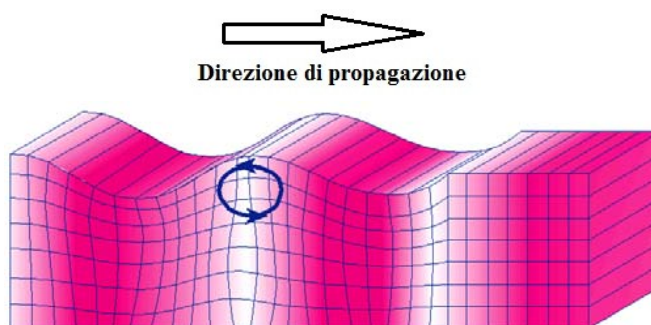
Fig. 1: Rappresentazione grafica della propagazione delle onde superficiali di Rayleigh, caratterizzata dall'oscillazione polarizzata in un piano verticale e con movimento retrogrado delle particelle rispetto alla direzione di propagazione dell'onda.
