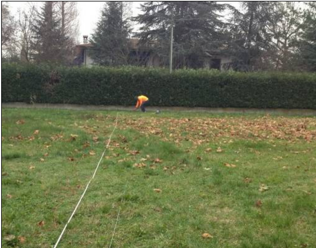
Impulso sismico per MASW
